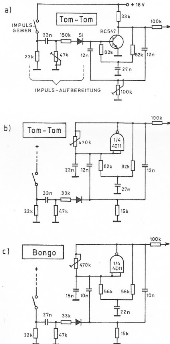
Abb. 6.2 Schaltbeispiele einiger elektronischer Schlaginstrumente: a) Tom-Tom-Schaltung mit einem Transistor; b) Tom-Tom-Schaltung mit dem IC 4011; c) Bongo-Schaltung, ebenfalls mit dem IC 4011
